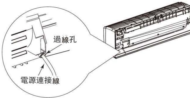
3. 取下固線夾，根據接線端子的識別符號及對應電源連接線顏色，把電源連接線連接到接線端子，並擰緊螺絲，用固線夾固定電源連接線。
