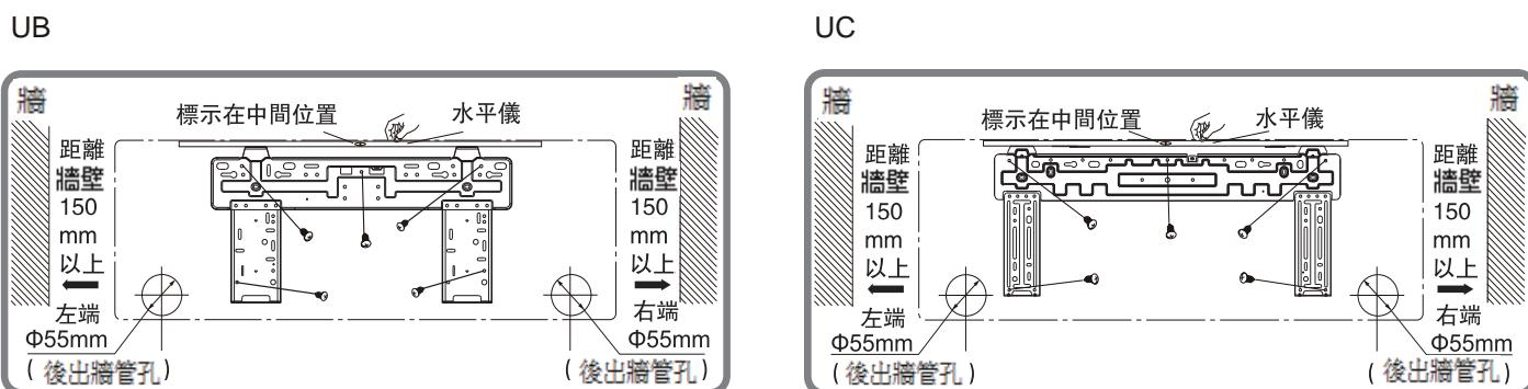
2. 在選定的出管位置上開一直徑為Φ55或Φ70的牆管孔。確保牆管孔應該內高外低，傾斜幅度在5–10°，以便順利排水，防止雨水倒流到室內。
