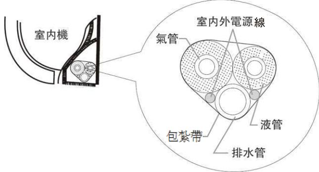
2. 包紮時，需提前預留排水管及電源線安裝所需長度。包紮到一定長度時，室內電源線單獨分出，然後排水管單獨分出。
